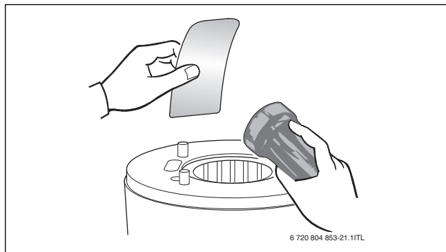
Рис. 52 Проверка наличия грязи в теплообменнике
