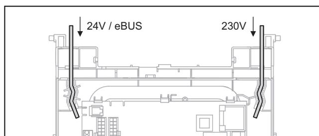
1. Проведите присоединительную проводку подключаемых компонентов через кабельный ввод слева и справа на нижней стороне блока электроники.
