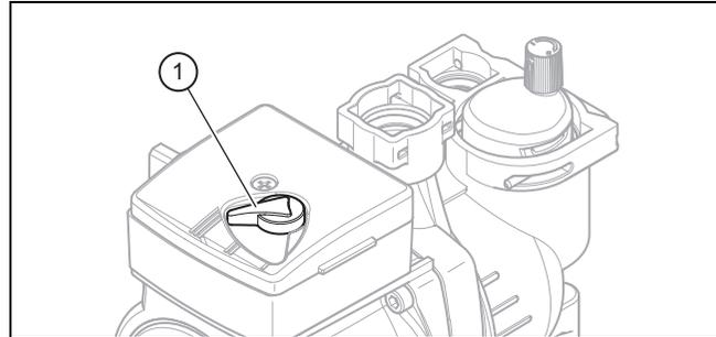
4. Установите выключатель (1) насоса системы отопления на желаемый уровень в соответствии с характеристиками системы отопления.
