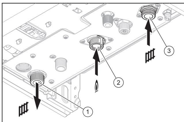
1. Выполните установку газопровода к подсоединению газа (2) без механических напряжений.
