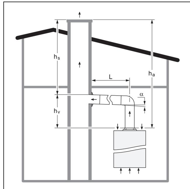
Вертикальный участок трубы ( $h_v$ ) должен составлять не менее половины горизонтального участка трубы ( $L$ ). Угол  $\alpha$  должен создавать небольшой подъём в сторону выхода.
