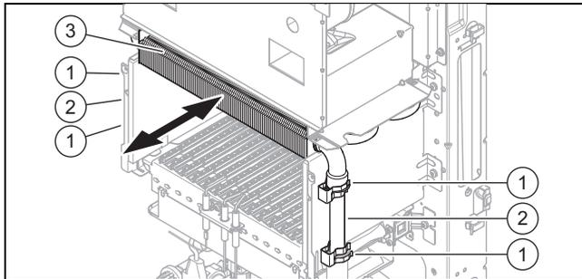
1. Снимите 4 скобы (1) на трубе подающей и обратной линии.
