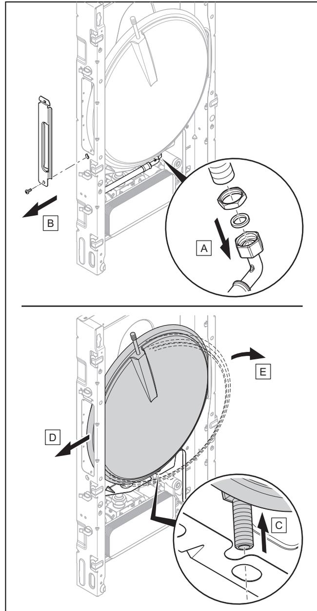
5. Снимите расширительный бак, как показано на рисунке.
