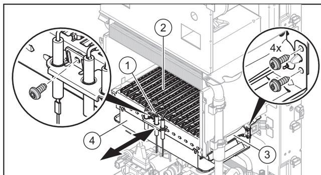
1. Открутите винты на газораспределительной трубе (**3**).
