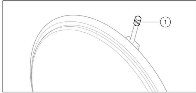
2. Проверьте давление на входе расширительного бака в зоне его вентиля (1).
