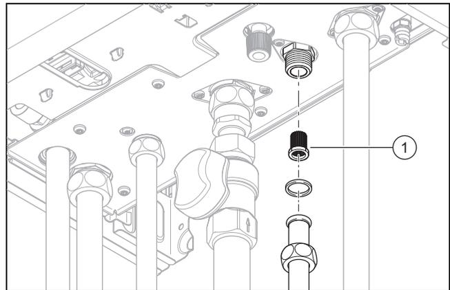
1. Очистите прибор со стороны горячей воды, открутив резьбовые соединения на трубопроводе горячей воды.
