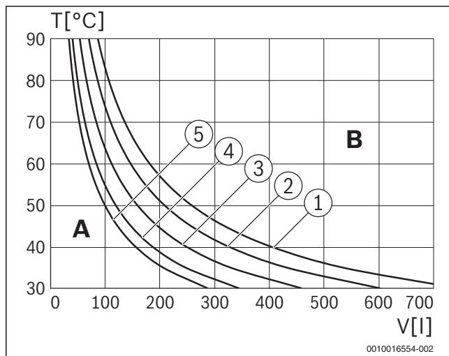
Рис. 13 Характеристики расширительного бака 8 л.
