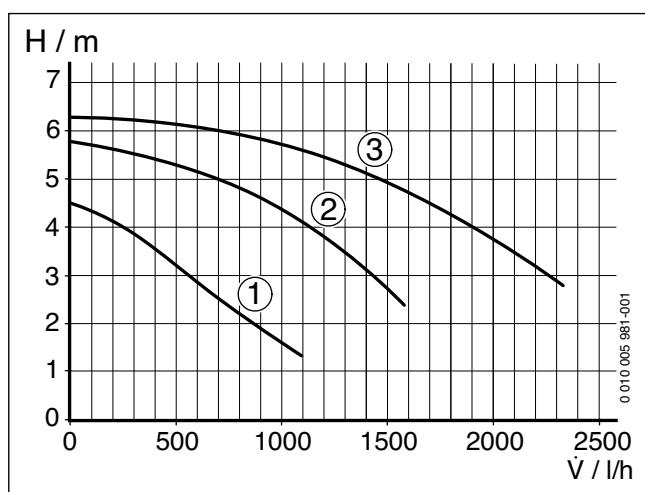
Рис. 30 Характеристики насоса отопительного контура (мощность котла = 35 кВт)
