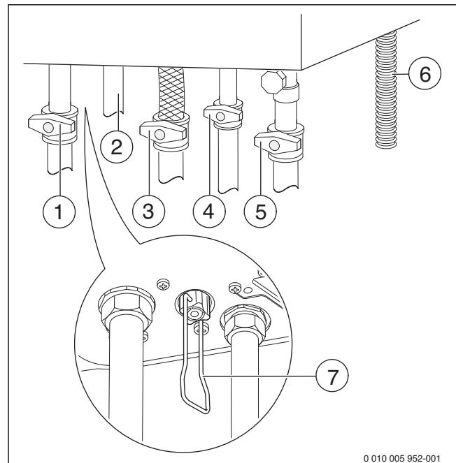
**Рис. 20 Подключения газа и воды (дополнительная комплектация)**
