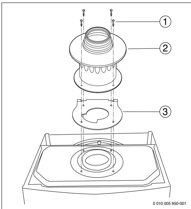
**Рис. 18 При отводе дымовых газов B<sub>22</sub> и мощности котла < 35 кВт:
