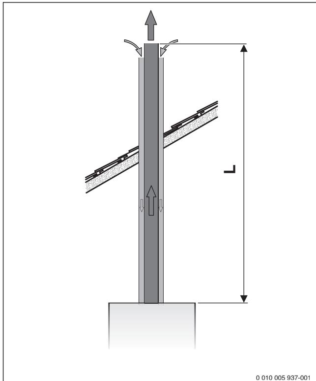
Рис. 8 Вертикальный отвод дымовых газов через концентрическую трубу C<sub>32</sub>
