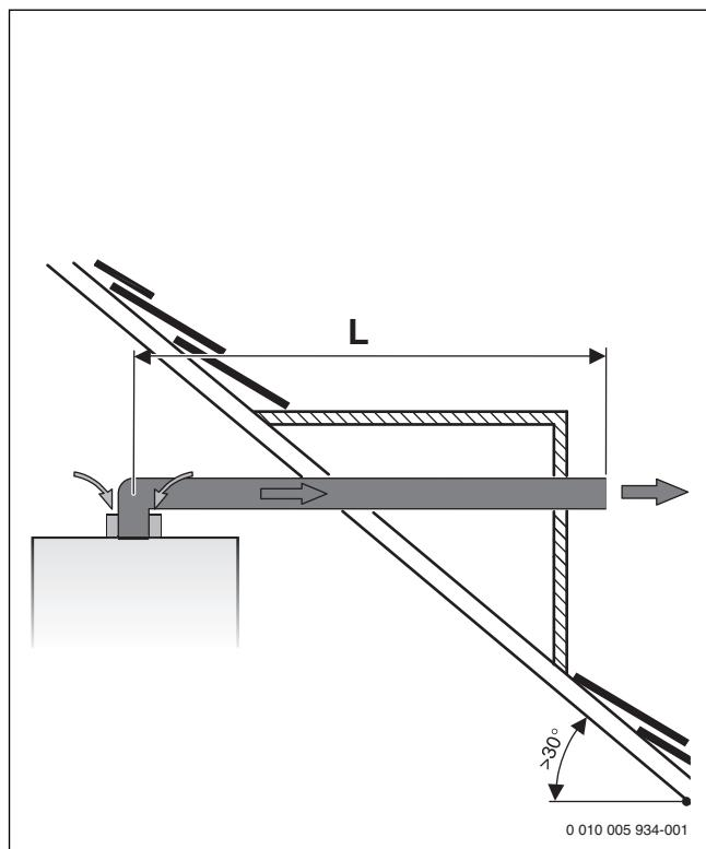
Рис. 4 Горизонтальный отвод дымовых газов B<sub>22</sub>
