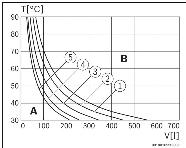
Рис. 12 Характеристики расширительного бака 6 л.
