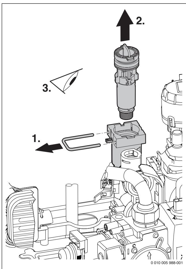
Рис. 36 Проверка фильтра в трубе холодной воды
