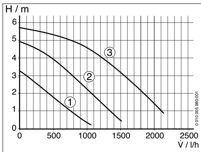
Рис. 29 Характеристики насоса отопительного контура (мощность котла < 35 кВт)
