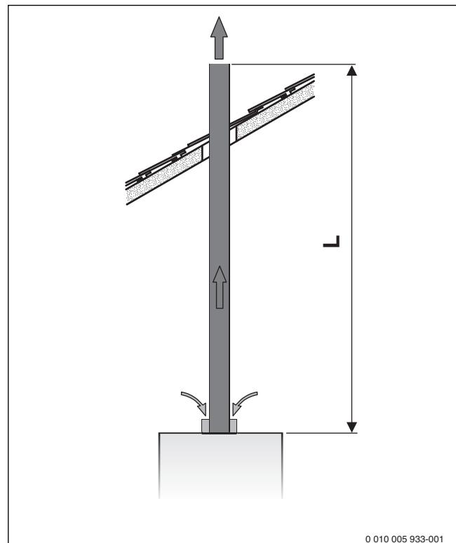
Рис. 5 Вертикальный отвод дымовых газов B<sub>22</sub>
