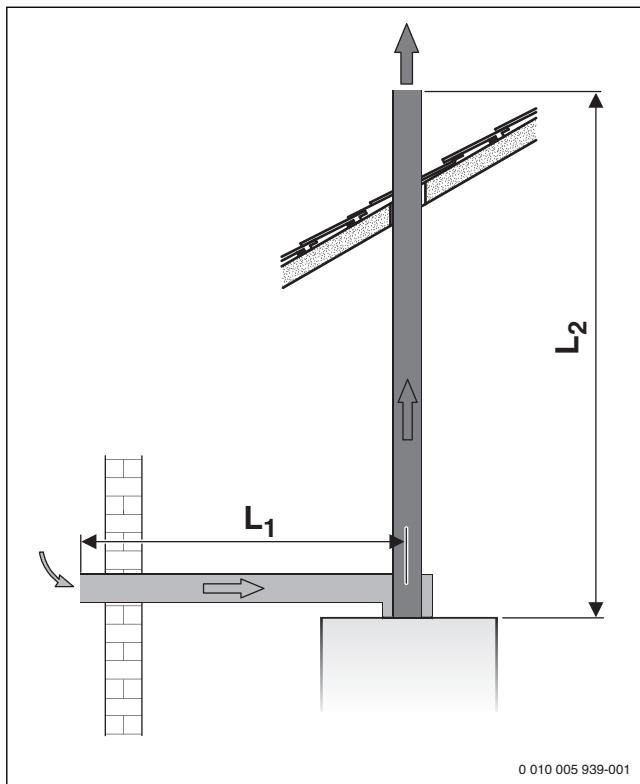
Рис. 10 Вертикальный отвод дымовых газов через отдельную трубу C<sub>52</sub>
