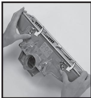
**6** Установите на место защитную пластины, сперва приставив ее к передней части амортизатора, после чего натянув ее на амортизатор на обратной стороне электрощетки ⑩. Закрепите защитную пластины с помощью двух защелок. ➤
