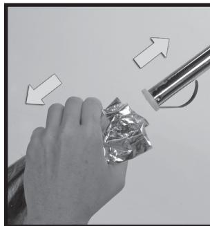
**5** Крепко возьмитесь за чехол с валиком и снимите с ручки аппликатора. Для этого стягивайте валик с ручки аппликатора, при этом прижимая его к ручке, чтобы сжать пружину фиксатора. Это позволит вам протянуть валик через концевую заглушку. Запаяйте чехол с валиком, чтобы он оставался влажным как можно дольше. Храните в заводской упаковочной трубке вдали от детей и животных до следующего использования. ➤
