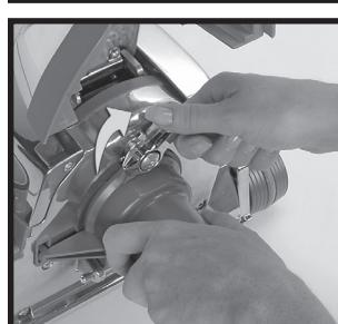
**5** Закрепите разъем удлинительного шланга, повернув фиксатор насадок ⑲ вправо (по часовой стрелке) до упора. (фиксатор насадок прижмет удлинительный шланг к устройству). Затем опустите колпак.
