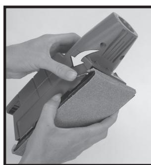
**4** Плотно оберните бумагой нижнюю часть Турбонасадки и воткните конец в зажим на обратной стороне. Зафиксируйте зажим. ►
