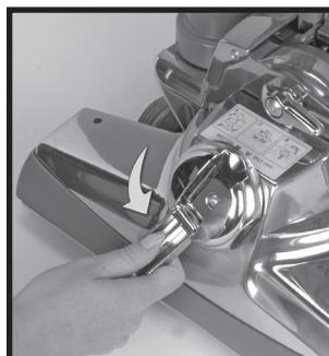
Для выполнения чистки прямым всасыванием, поднимите колпак ② и откиньте ручку на натяжителе ремня ⑩. С ее помощью поверните натяжитель ремня влево до упора (против часовой стрелки) до совпадения красных стрелок. При этом ворсовальный валик перестанет вращаться.
