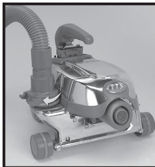
**6** Наденьте больший конец удлинительного шланга на выхлопной патрубок ⑯. Совместите стрелку на конце шланга со стрелкой на выхлопном патрубке и с усилием поверните разъем шланга вправо (по часовой стрелке), чтобы он сел на место.
