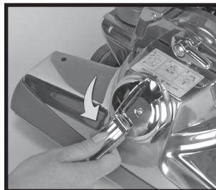
**2** Откиньте ручку на натяжителе ⑩. Держась за нее, поверните натяжитель влево (против часовой стрелки) до упора, чтобы совпали красные стрелки. При этом ремень растянется и поднимется над валом двигателя. Поверните ручку на натяжителе ремня обратно в ее первоначальное положение. ➤
