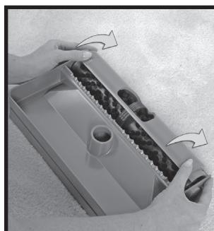
**7** Чтобы прочистить щетку, нажмите на защелки по краям пластмассовой защитной крышки, поверните ее и выньте из щетки.
