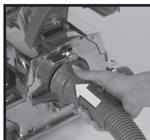
**4** На конце соединителя удлинительного шланга вы заметите два крючка. Зацепите крючки за концы присоединительного патрубка ⑲, затем с усилием вставьте шланг в отверстие системы **Sentria**. ➤
