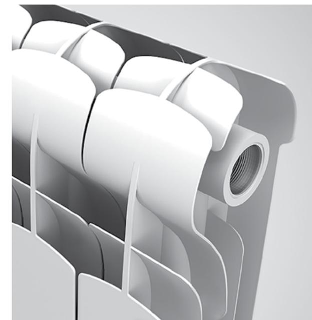
Запоминающийся дизайн, совершенство линий и эффективная конвекция радиатора Indigo продолжают историю успеха Royal Thermo. В модели применена запатентованная технология POWERSHIFT®. Дополнительные ребра на вертикальном коллекторе позволяют увеличить площадь теплоотдачи. Благодаря этому мощность каждой секции увеличена на 5%.
