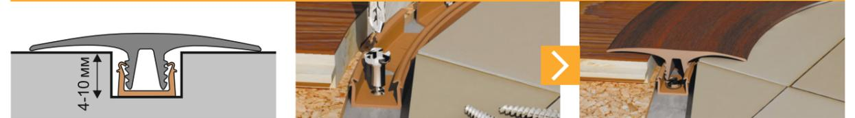
**2. Как стыкоперекрывающий профиль (выравнивающий)** помогает соединить участки пола, имеющие разную высоту (перепады до 12 мм.)
