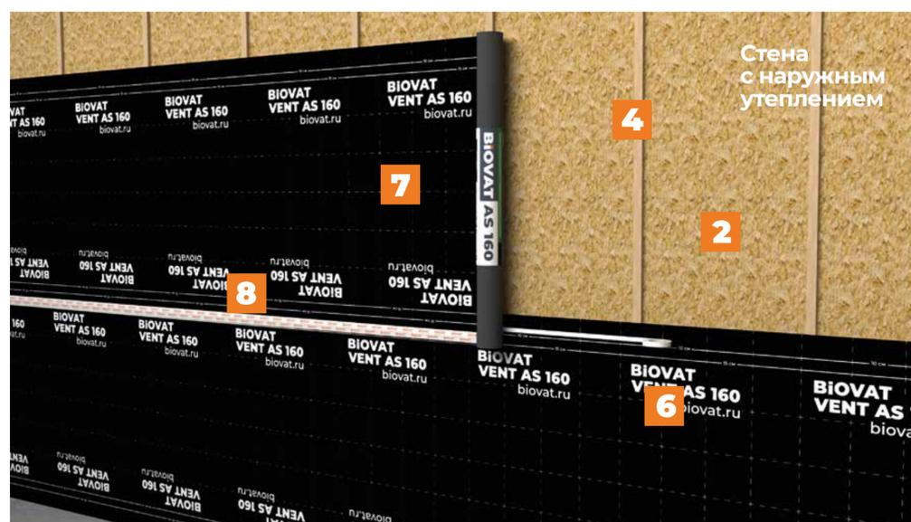
В конструкции стены с наружным утеплением паропроницаемая диффузионная мембрана применяется для защиты утеплителя и несущих элементов конструкции от конденсата, ветра и атмосферных осадков, проникающих под внешнюю отделку.
