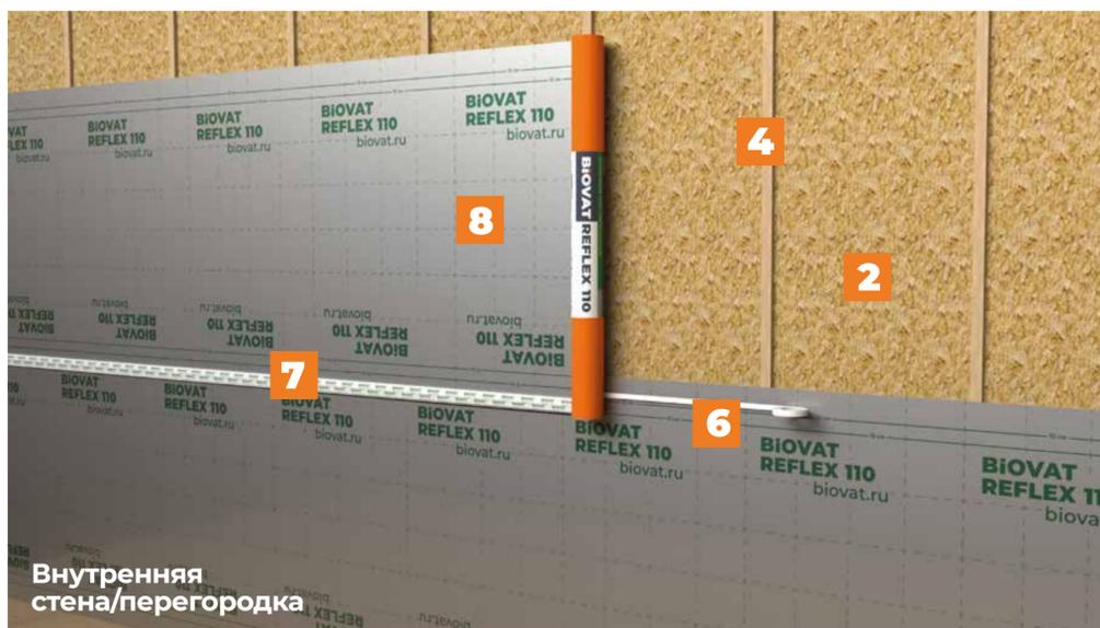
В конструкциях каркасных стен, внутренних стен и перегородок пароизоляционная мембрана применяется для защиты утеплителя и внутренних элементов конструкции от проникновения паров воды изнутри помещения и отражения тепловых излучений, что позволяет сохранить тепло внутри помещения, а также для предотвращения проникновения частиц волокнистого утеплителя во внутреннее пространство здания.
