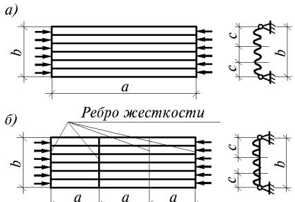
Рис.7.9. Расчетная схема сжатого гофрированного листа
