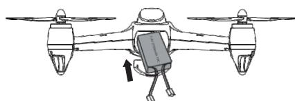
1. Установите аккумулятор в аккумуляторный отсек модели.
