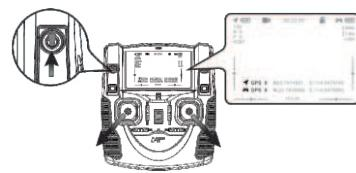
После поиска спутников, разблокируйте управление и модель зафиксирует координаты точки взлета. После чего, при необходимости, вы можете пользоваться функцией автоматического возврата в точку взлета .
