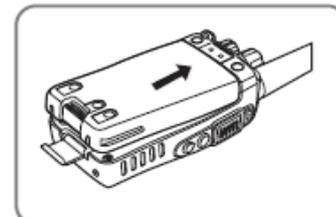
Для снятия аккумулятора откройте защелку и потяните аккумулятор вверх за нижнюю часть
