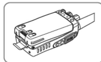
Прижмите нижнюю часть аккумулятора и закрепите защелкой
