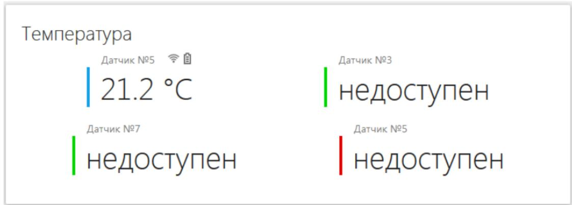
В разделе отображаются все зарегистрированные (подключенные) к термостату термодатчики и измеряемые ими температуры. Если термодатчик радиоканальный, то рядом с ним указаны данные о состоянии элемента питания (заряд) и качестве (уровне) приема радиосигнала.
