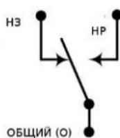
Для управления котлом термостат ZONT имеет на 1, 2 и 3 выходе 6-ти контактного разъема контакты встроенного реле. Контакты имеют обозначение "ОБЩИЙ", "НЗ" и "НР". К котлу надо подключить два из трех контактов.
