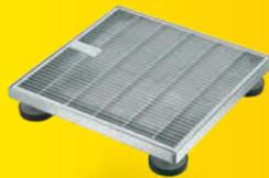
Для террас и зеленых кровель. С четырьмя плавно регулируемые по высоте резинометаллическими опорами, высота 70-110 мм. Решетка с размером ячеек 9 x 64 мм. Класс нагрузки L 15 для размера 500 x 500 мм. Класс нагрузки Н 1,5 для размеров 300 x 300 мм и 400 x 400 мм.
