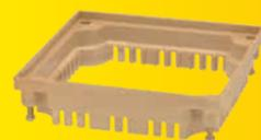
из полиуретана, 400 x 400 мм, с четырьмя регулируемыми по высоте латунными шпильками. Высота: 50-80 мм, штабелируемый. Класс нагрузки L 15.
