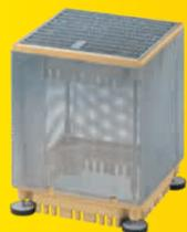
из полиуретана, 400 x 400 мм, с горячеоцинкованной концевой решеткой с размером ячеек 9 x 32 мм и перфорированной рамой из алюминия. Укорачивается на месте установки до 230 мм. Специальная высота до макс. 1070-1100 мм возможна. Изготовление на заказ.
