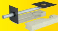
Комплект парапетной воронки состоящий из сваренного соединительного фартука из материала по желанию заказчика, в соответствии с DIN EN 1253-2 с повышенным стандартом качества согласно RAL GZ-694, выпускной трубы из нержавеющей стали DN/OD 70/75, страховочного хомута, пароизоляционной плиты и изоляционной плиты. Изоляционная плита из PUR с размерами 1.000 x 500 x 120 мм, изоляционная плита из минеральной ваты с размерами 990 x 480 x 120 мм, уклон выпускного патрубка 1°.
