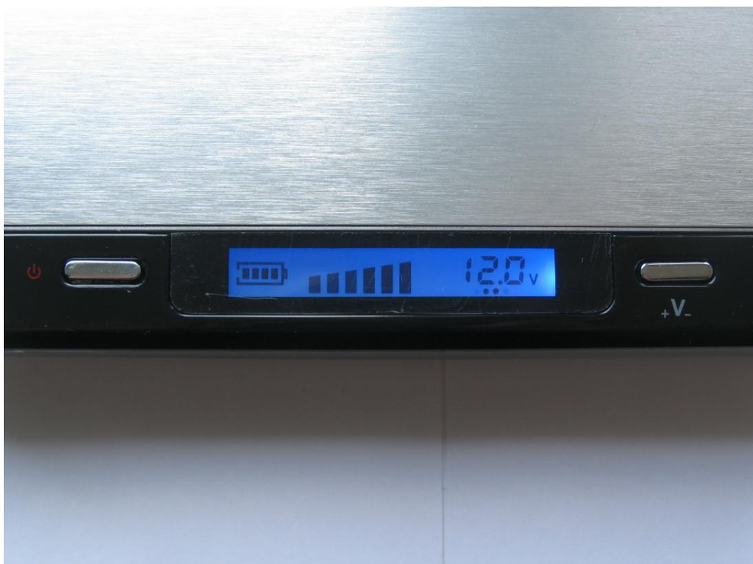
Справа клавиша включения дисплея (нажать и удерживать 3-4 с), слева клавиша +V- для установки выходного питающего напряжения, подаваемого на электронный прибор. Последовательным нажатием на эту клавишу можно выбрать питающее напряжение 12 V (лазерный активатор питается именно этим напряжением), 16 V, 19 V. На передней панели источника питания расположен разъем DV OUT, в который вводится разъем от питающего кабеля.
