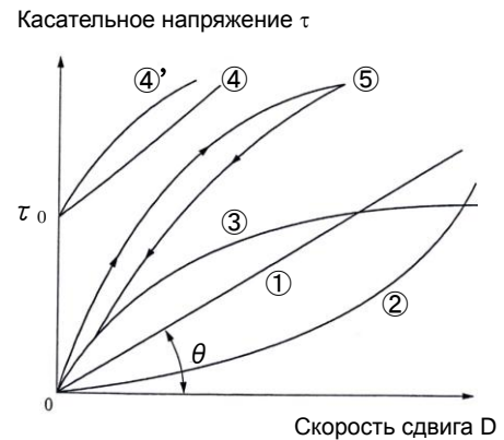
Диаграмма 3. Ньютоновские и неньютоновские среды (Hiroshi Matsuyama, Jitsuyo Kogyo Bunseki, 61, Syoenergy Center, 2001)
