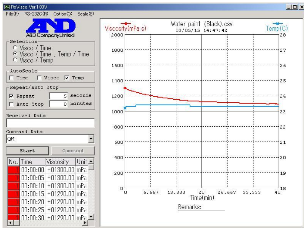
Диаграмма 20. Пример измерения вязкости краски на водной основе (SV-10)
