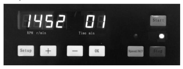
Для отображения на дисплее центробежного ускорения нажмите кнопку «**Speed/RCF**». Загорится индикатор «**Speed/RCF**», в правом нижнем углу на дисплее рядом со значением центробежного ускорения будет гореть точка.
