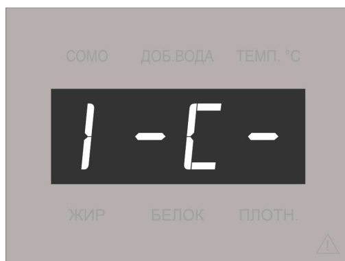
Рисунок 2.3 – Требуется слить пробу
