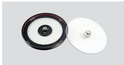
Гематокритный ротор V2 на 24 капилляра Макс. скорость 13 000 об/мин. Макс. ОЦУ 16 058 × g. № по каталогу: 30472304.
