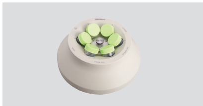
Угловой ротор, 6 × 50 мл Макс. скорость 6000 об/мин. Макс. ОЦУ 4427 × g. Радиус 30 мм. № по каталогу: 30130878.
