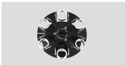
Бакетный ротор, 6 × 5 мл Макс. скорость 4000 об/мин. Макс. ОЦУ 1878 × g. Радиус 14 мм. № по каталогу: 30130880.
