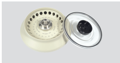
Угловой ротор V2, 24 × 1,5/2,0 мл, BIOSEALS Макс. скорость 13 500 об/мин. Макс. ОЦУ 17 317 × g. Радиус 11 мм. № по каталогу: 30472302.
