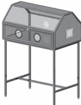
Предназначен для проведения работ, нуждающихся в стерильных условиях (микробиологических и бактериологических лабораториях). Герметичная конструкция снабжена бактерицидной лампой. Для проведения работ внутри бокса предусмотрены прозрачные защитные стекла и две пары рукавов (резиновых перчаток). Габаритные размеры: 1000×700×1380
