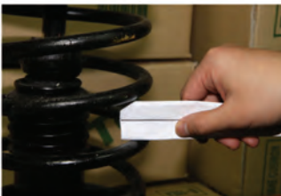
измерение шага пружины линейкой
