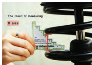
измерение шага пружины измерителем
