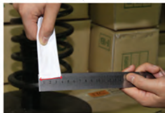
измерение шага пружины линейкой
