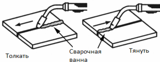
Рисунок 20. Направление движения горелки
