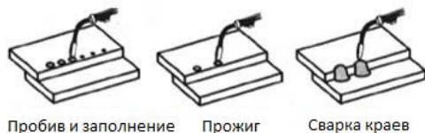
Рисунок 26. Методы MIG сварки точками.
