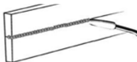
Рисунок 22. Сварка в горизонтальном положении
