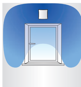
Schemat intensywności nawietrzania w zależności od stopnia regulacji przepływu strumienia powietrza
