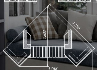
ОБЛИЦОВКА УГЛОВАЯ С КАМЕННОЙ БАЛКОЙ
