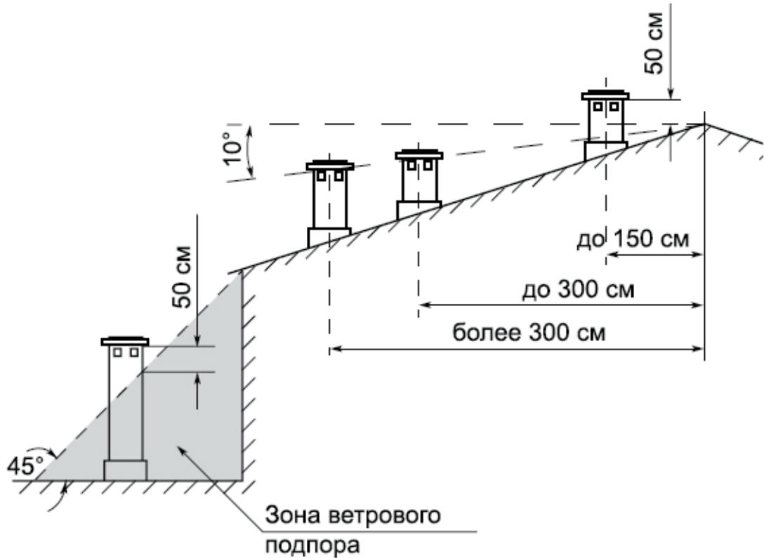
**2.3.3** Зона ветрового подпора определяется плоскостью, проходящей под углом 45 градусов к горизонту через наиболее высокую линию соседнего здания или другого сооружения, деревьев.
