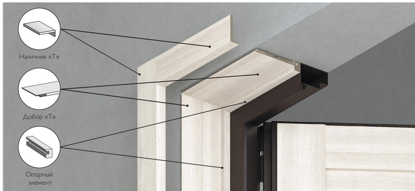
СХЕМА СОЕДИНЕНИЯ ДОБОРОВ С ИСПОЛЬЗОВАНИЕМ ШПОНКИ
