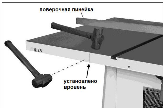
Рис. 5-5: выравнивание удлинений стола, способ 1
