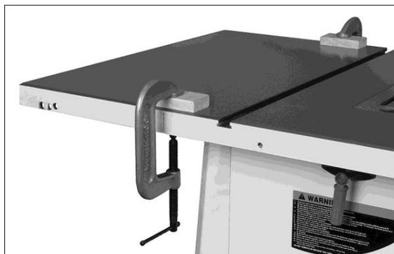
Рис. 5-6: выравнивание удлинений стола, способ 2
