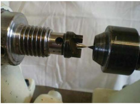
Фото 6. Проверка соосности центров станка
