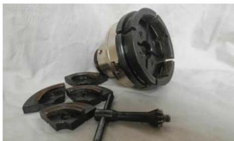
Фото 11. Четырехкулачковый патрон Axminster с дополнительным набором кулачков С
