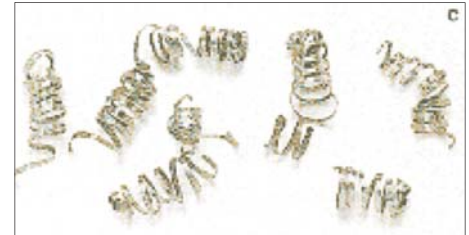
Свободно намотанная (витая) стружка – идеальные условия резания
