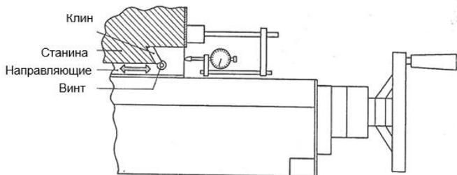
Повторите ту же процедуру по отношению к вертикальным салазкам стола и горизонтальным салазкам шпиндельного узла.
