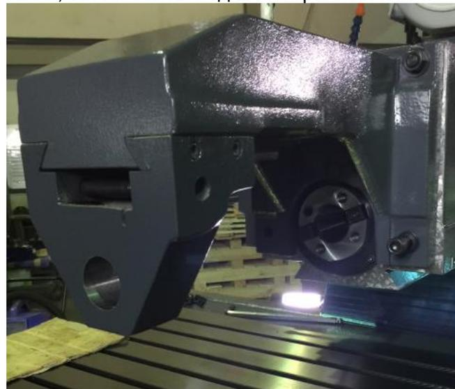
На установленный фиксатор навешивается серьга, удерживающая свободный конец оправки.
