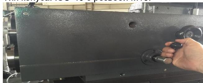
Для установки фиксатора горизонтальной оправки необходимо присоединить его к фрезерной головке, затянув сначала верхние гайки, затем болты под шестигранный ключ.
