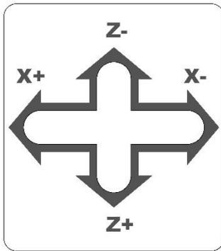
Выбор направления движения выполняется сцепным рычагом (Р, рис.3). Включение подачи (С, рис.2) и выбор скорости (А, рис.2) подачи осуществляется с пульта управления. Переключать направление подачи можно только при выключенном двигателе подачи и скорости подачи, установленной на минимум.
