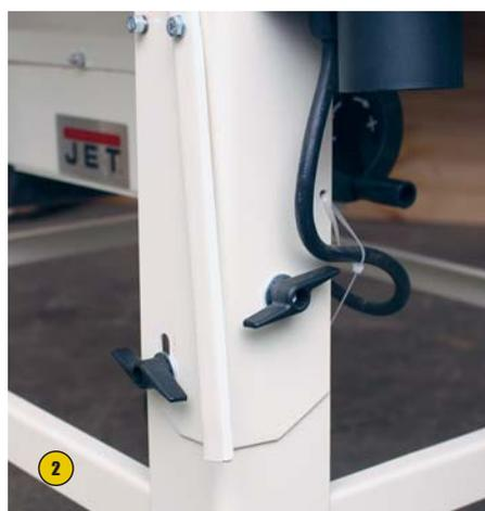
Станок рассчитан на работу с диском диаметром 315 мм. Размер для такой «весовой категории» более чем солидный, и это — очередное преимущество модели. Для доступа к диску и расклинивающему ножу снимают вставку стола (3). Станки с таким диском обычно не имеют возможности его наклона. Этот — имеет (4). Вращая верхнюю рукоятку-«маховичок», меняют угол наклона, нижнюю — вылет диска. Также
