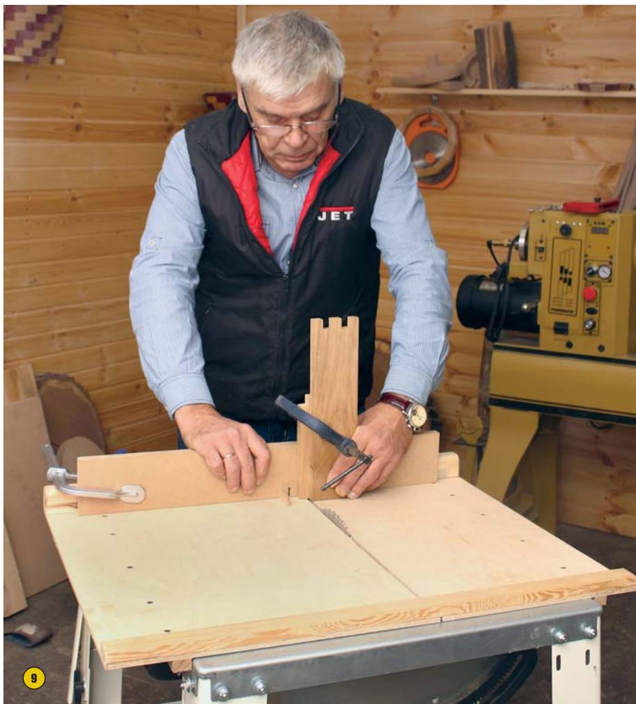
Для начала ставим подвижной стол на стол станка и устанавливаем глубину пиления, равную толщине заготовок. Ничего ловить или вымерять не надо, для этого есть простой (хотя и не очевидный) приём (11). Кстати, так и проводим разметку — в дальнейшем несколько раз потребуется отмерять расстояния, равные толщине заготовки — отмерять их будем «второй заготовкой».
