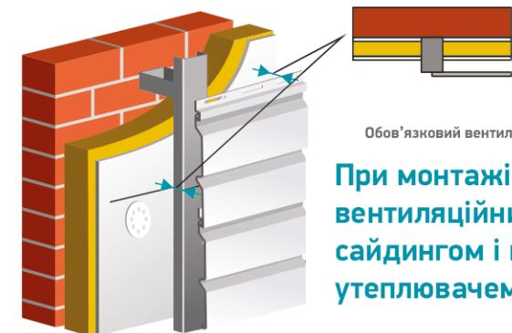
Обов'язковий вентиляційний проміжок 30-50мм
