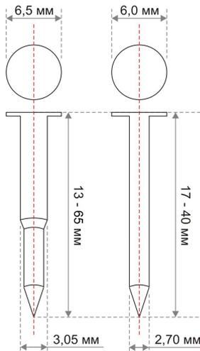
Диаметр 2.7 мм длина **17 мм**, гальванизированный
