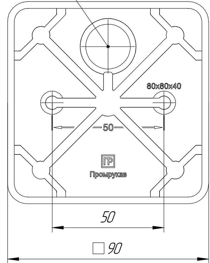
*Коробка распределительная 60-0210 для прямого монтажа двухкомпонентная безгалогенная (HF) 80x80x40*
