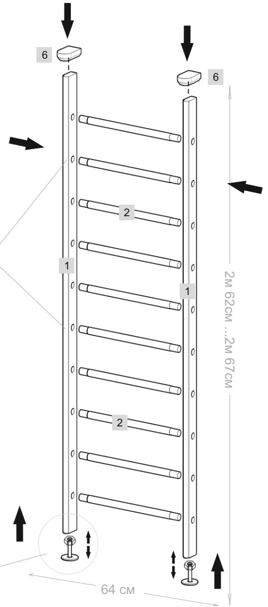
собираем нижнюю часть крепления и за счет болта №9 регулируем высоту
