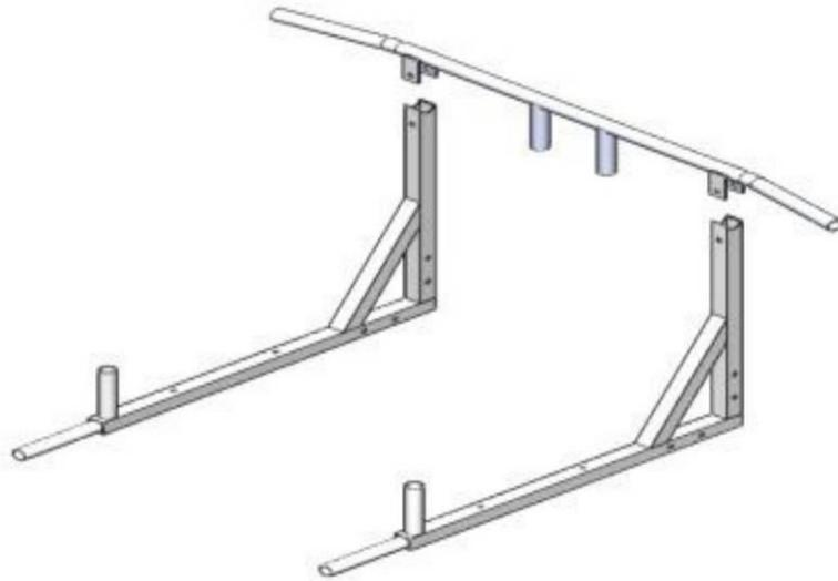
3.6. Установите перекладину 1 и перекладину 2 (поз. 3,4) используя болты (поз.11), в соответствии с рисунком ниже, затяните все гайки:
