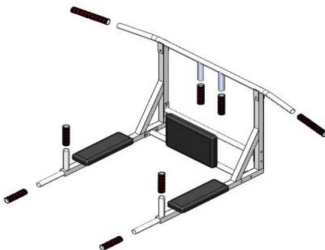
3.9. Головки болтов и гайки закройте колпачками М8 (поз.17).
