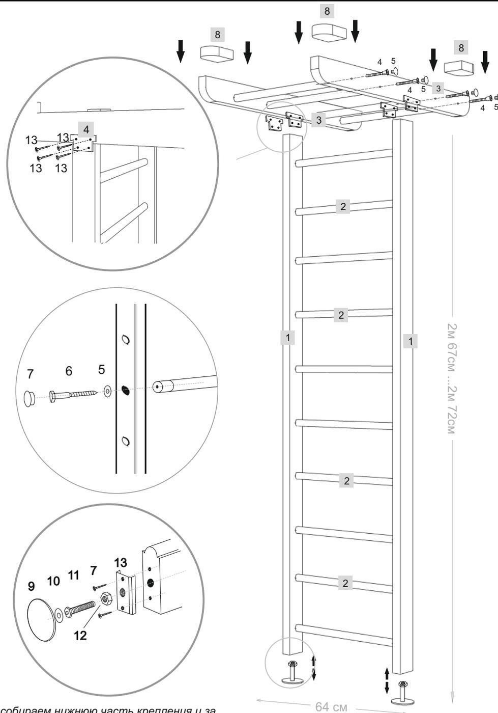
собираем нижнюю часть крепления и за счет болта №12 регулируем высоту
