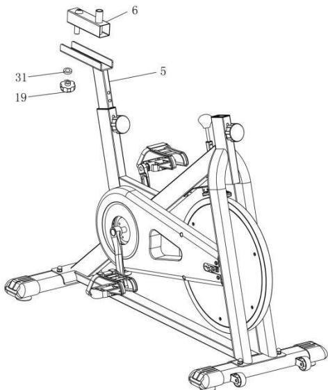
Закрепите соединительную деталь сиденья (6) в детали регулировки сиденья (5). Болт, приваренный к соединительной детали (6), должен оказаться в пазу детали регулировки сиденья (5). Заденьте его с помощью гайки (19).
