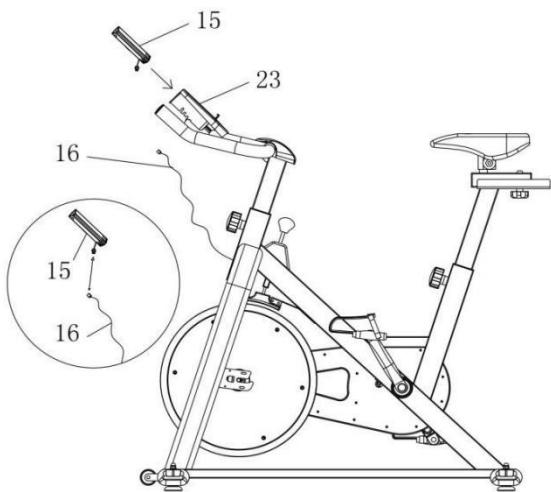
Закрепите пластиковую подставку (23) и компьютер (15) как показано на рисунке. Затем соедините кабель компьютера (15) с кабелем тренажера (16)
