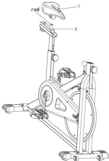
Наденьте сиденье (7) на соединительную деталь (6). Плотно заденьте его, затянув две гайки под сиденьем (7).
