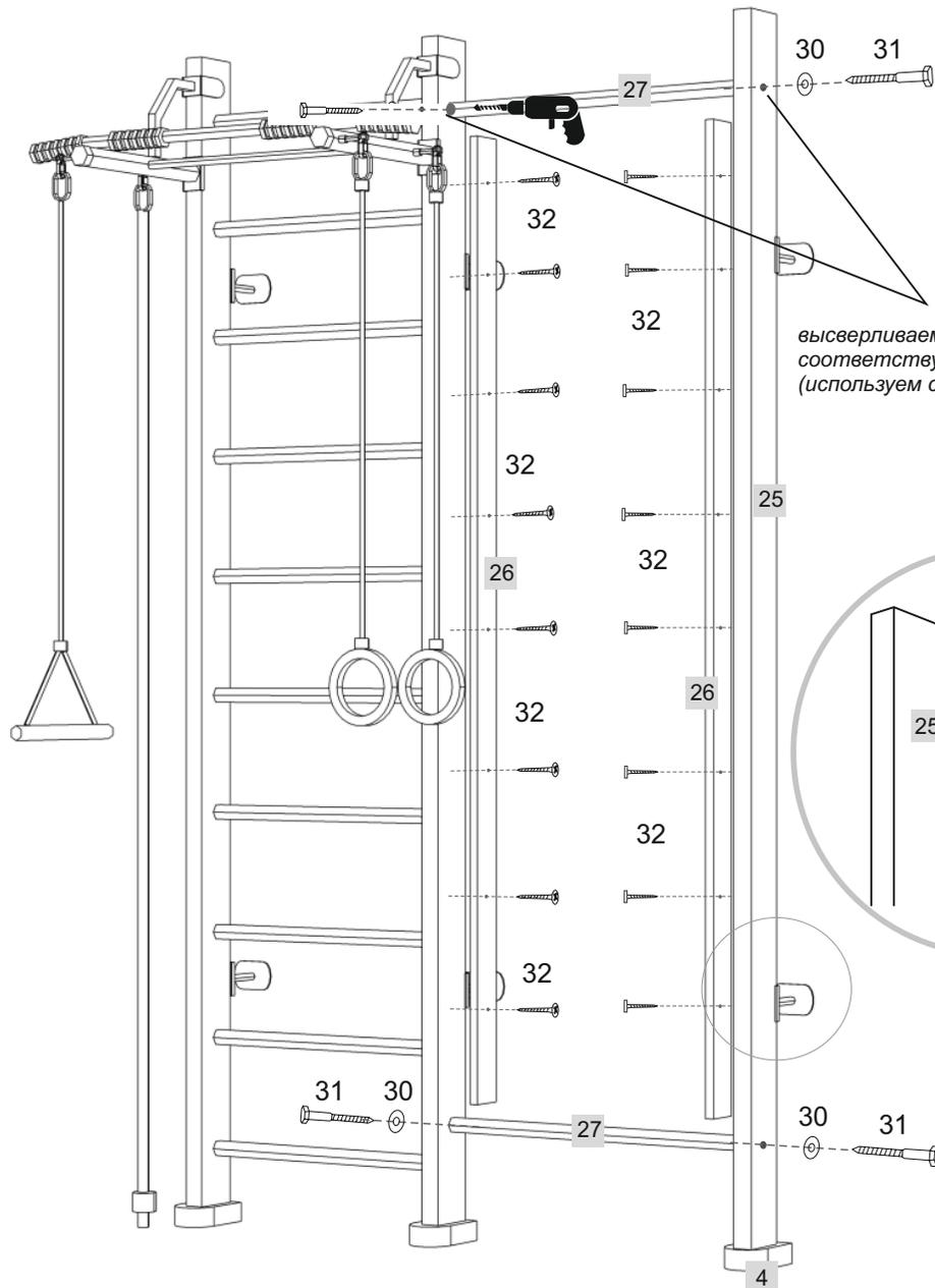
*высверливаем в стойке ДСК отверстия, соответствующие на стойке для скаподрома (используем стойку №25, как шаблон)*
