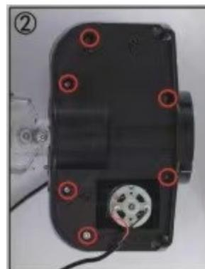
2. Открутите 6 винтов, при помощи отвертки.
