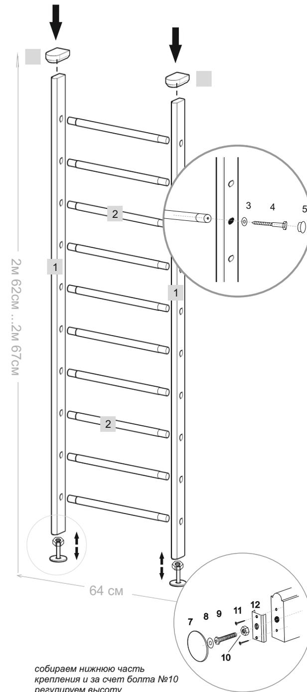
собираем нижнюю часть крепления и за счет болта №10 регулируем высоту
