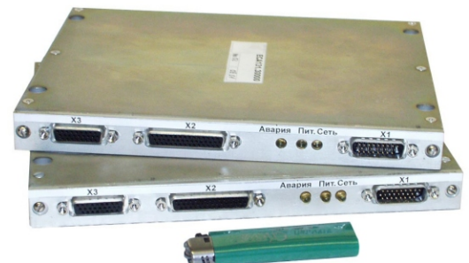
Источники вторичного электропитания базовой корабельной ЭВМ специального назначения «Багет-ВМФ».
