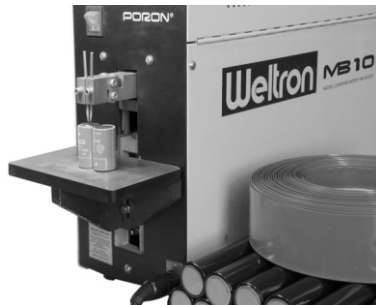
Рис.2 Сварочное оборудование и термоусадочная пленка для изготовления аккумуляторных батарей.
