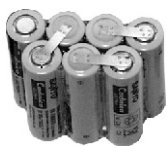
Рис.7 Образец контактной сварки с помощью перемычек на аккумуляторной батарее.
