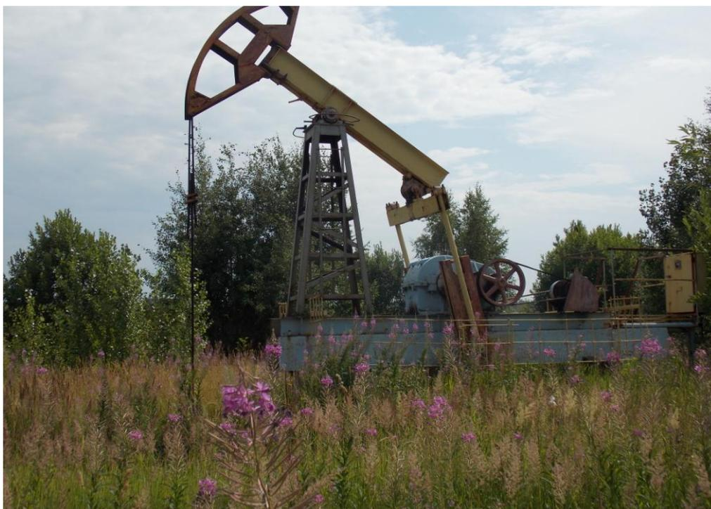
Рис. 3. Оборудование устья водозаборной скважины № 2
