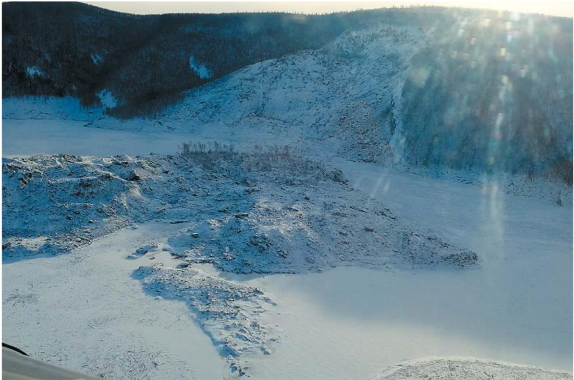
Рис. 3. Стенка срыва пород (на заднем плане вверху), рыхлые обвальные образования (лопастевидной формы в плане поперёк вдхр) с небольшим блоком оползневых, маркирующихся «пьяным лесом» ближе к стенке срыва (фото [3, с.15])
