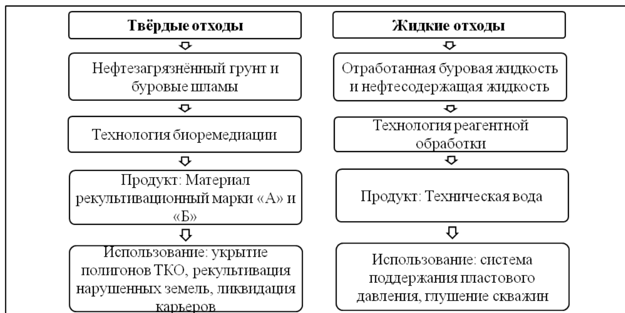
Рис. 2. Схема обработки и утилизации нефтесодержащих и буровых отходов с получением товарных продуктов [8]
