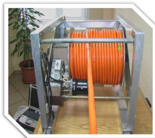
Рис.3. Лебедка каротажная (вид спереди) [6]
