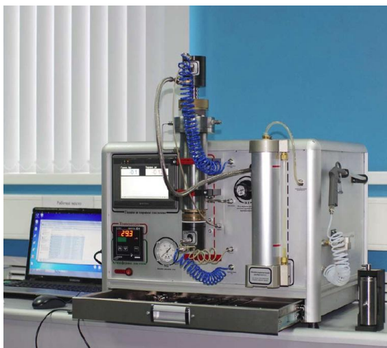
Рис. 1. Автоматизированный прибор для измерения пористости и проницаемости ПИК-ПП [11]
