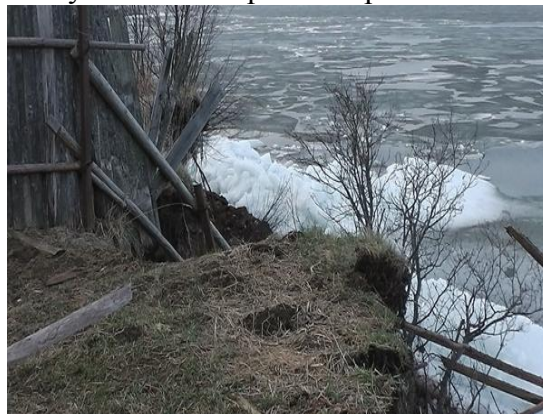
Рис. 4. Новые трещины в грунте берегового уступа
