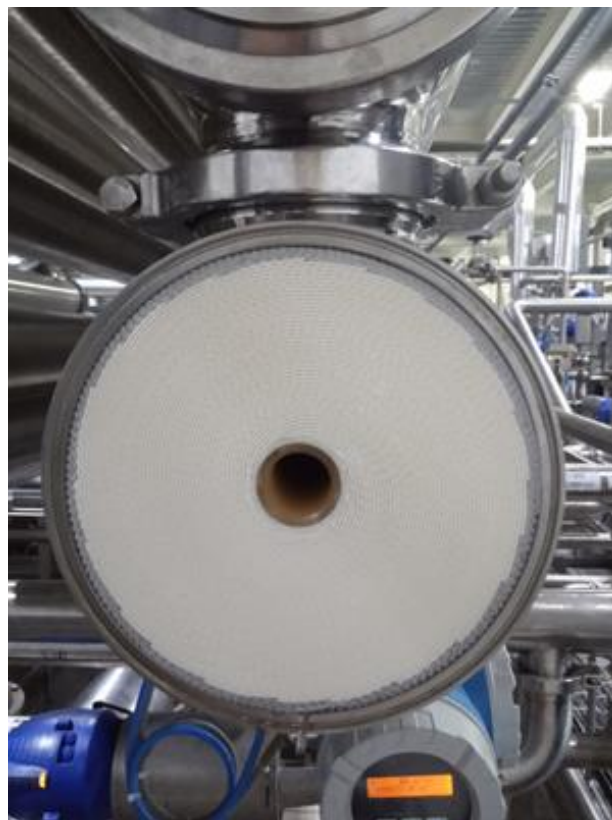
Рисунок 2. Санитарный мембранный элемент SNUF 8038-10-46 для концентрирования белка.
