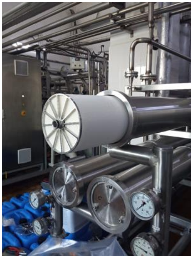
Рисунок 1. Санитарный мембранный элемент SNMF 8038-31 для сгущения сыворотки.
