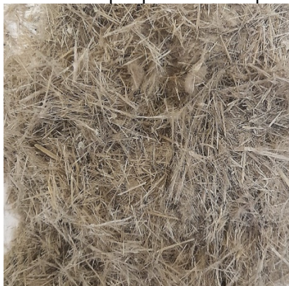
Рисунок 2 – Волокнистый материал, полученный из стеклоармированных стержней
