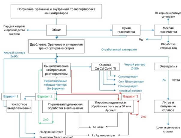
Рисунок 1 - Упрощенная схема получения целевых продуктов из рудного концентрата первичного сырья.
