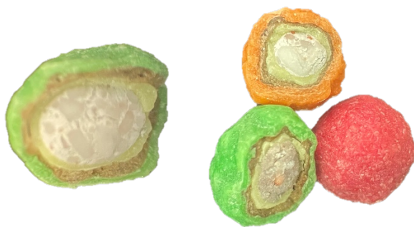
Рисунок 2 - Образцы многослойного удобрения пролонгированного действия на основе NPK 16:16:16
