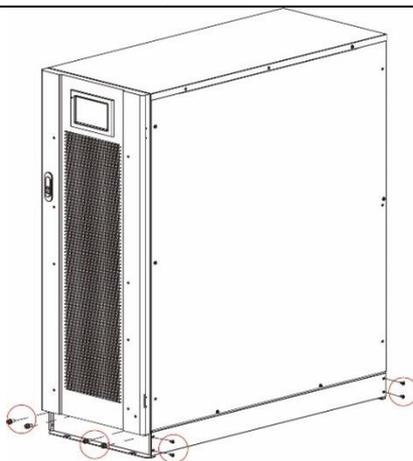
Рисунок 19. Закрепление деталей на корпусе
