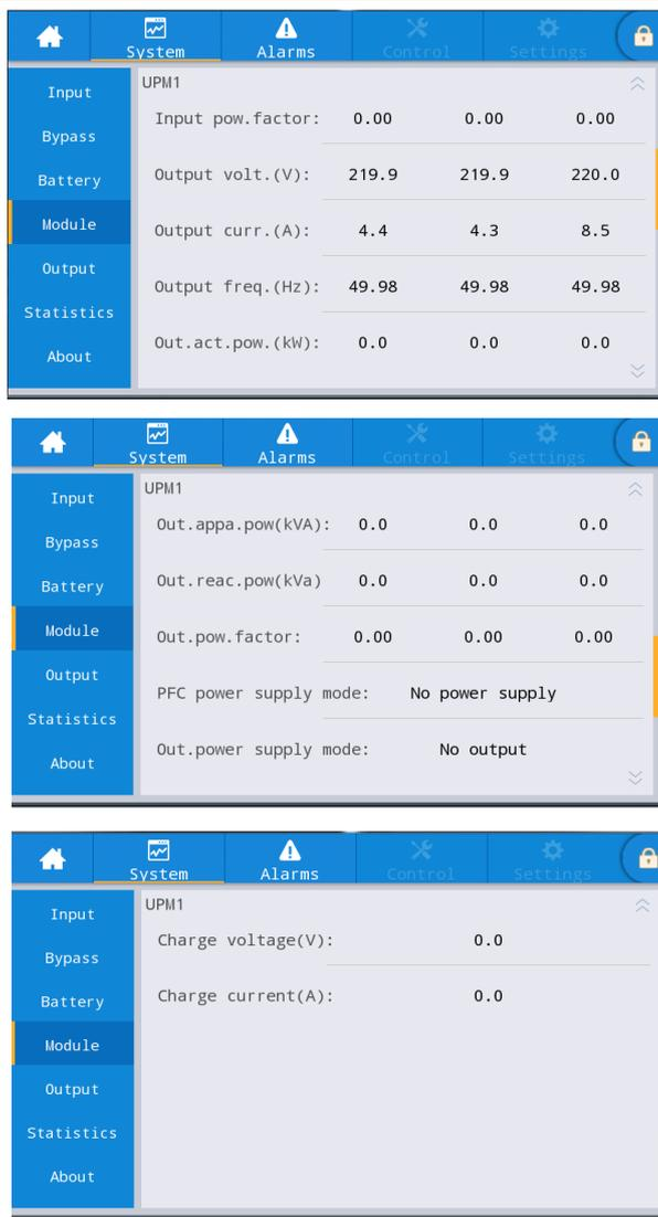
Рисунок 46. Интерфейсное меню параметров силового модуля.
