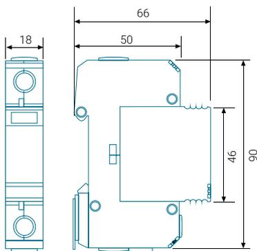
Однополюсное УЗИП класса II коммутирующего типа.
