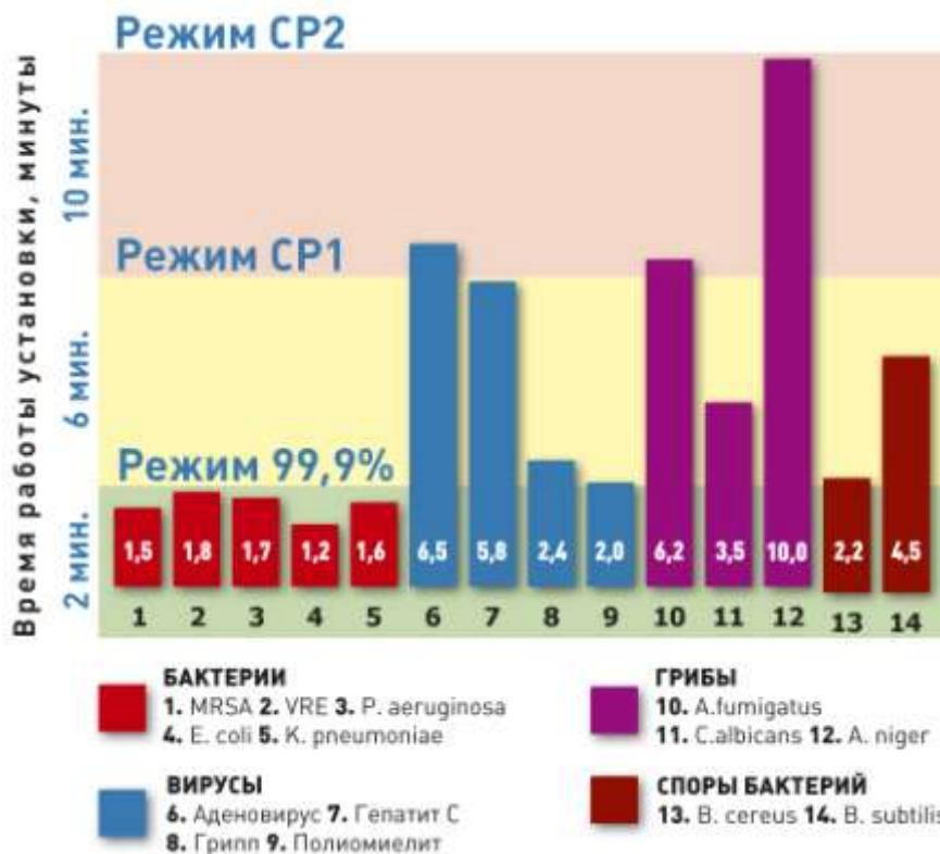
**Рис. 7.** Время работы импульсной УФ-установки для инактивации различных видов микроорганизмов.
