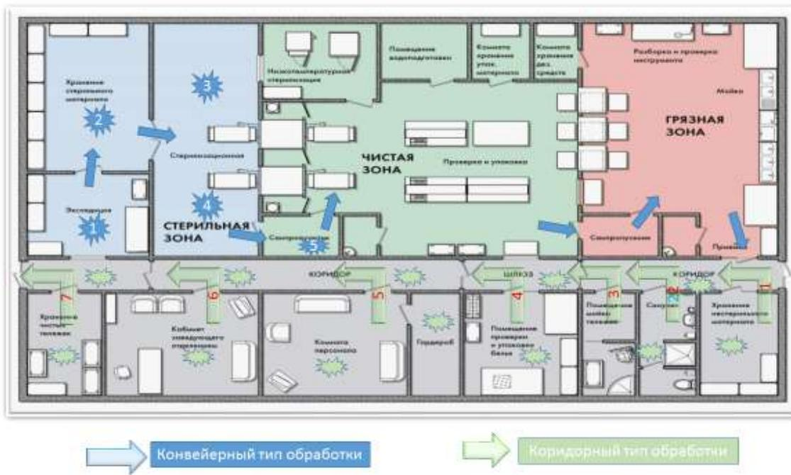
**Рис. 8.** Последовательность обработки зон ЦСО импульсной УФ-установкой.
